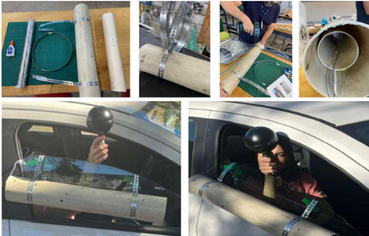
Figura 6: Etapas da construção do abrigo e sua instalação.
