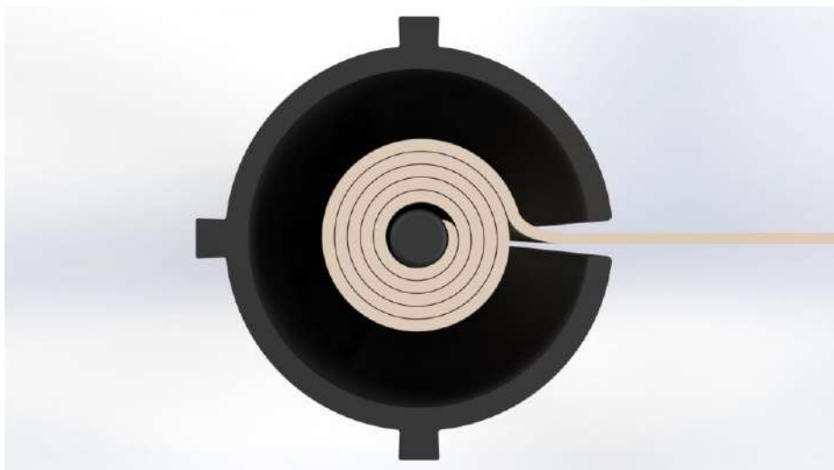
Figura 11 - Vista em corte do tubo com a lona sendo puxada.
