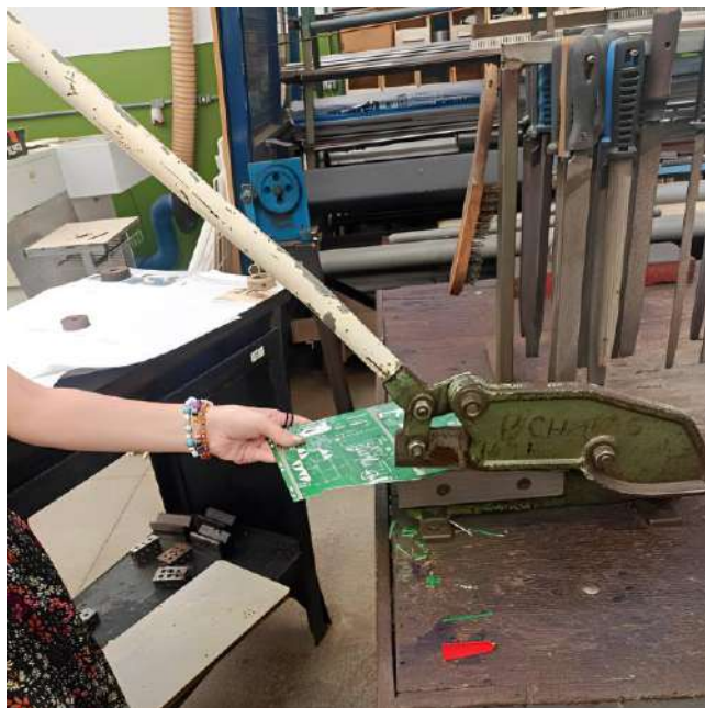
Figura 10 - Cortes da PCB na guilhotina.
