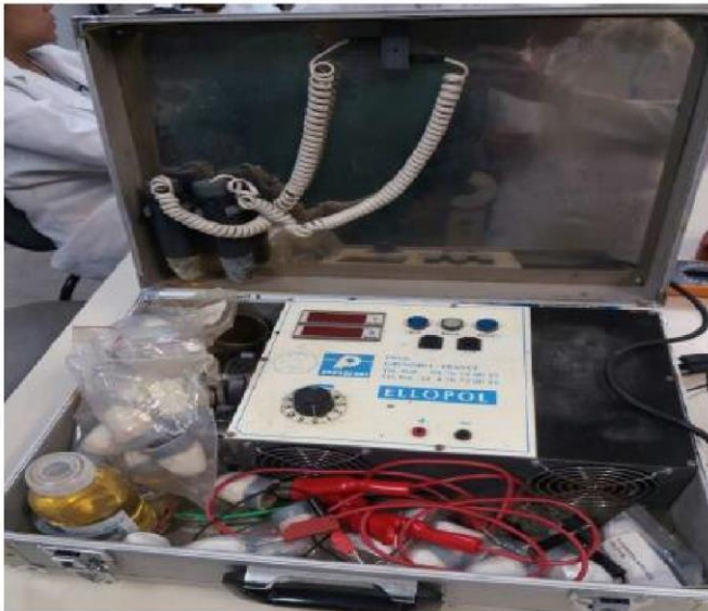
Figura 1: Equipamento Potenciômetro utilizado na prática de eletrodeposição.
