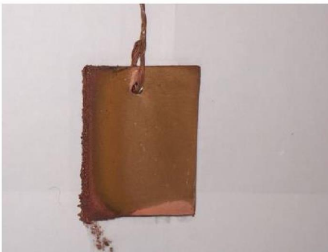
Figura 2: Amostra de chapa 2.25 mm Aço 1020 com superfície revestida de cobre.
