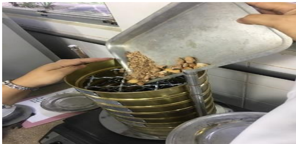
Figura 3 – Início do peneiramento grosso em um dos solos amazônicos estudados.
